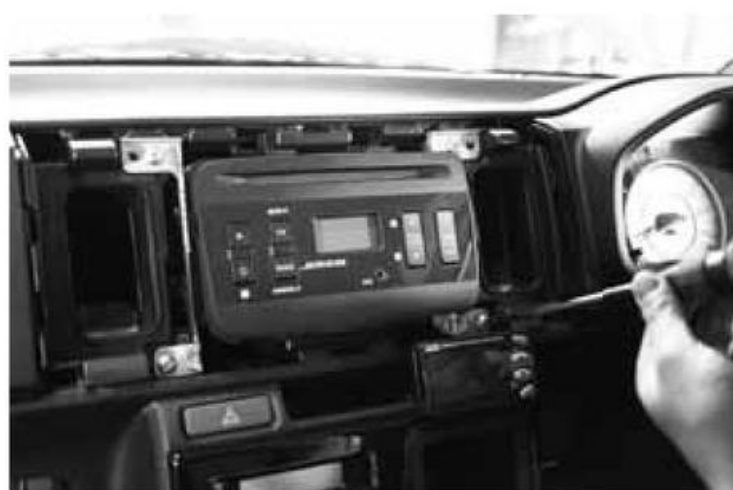
オーディオパネルが外れたら、オーディオユニットの上下にある4箇所のスクリーネジをプラスドライバーで緩める。
