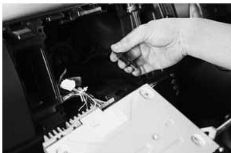
オーディオユニットを取り外すには、まずは手にしている黒いアンテナ線を抜き去る。
