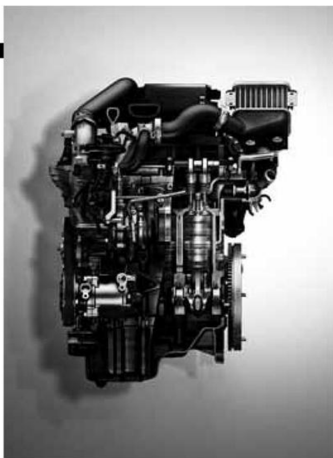
R 06 A型ターボエンジン。出力は自主規制値の64psに抑えているが、トルクはターボRSで10Kg・m、ワークスでは10.3Kg・mまで引き上げた。
