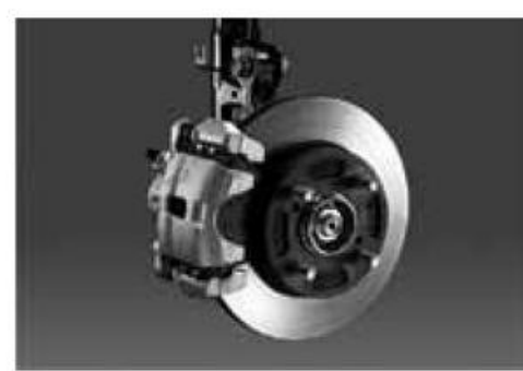
ブレーキはフロントに13インチサイズのベンチレーテッドディスクを採用した。
