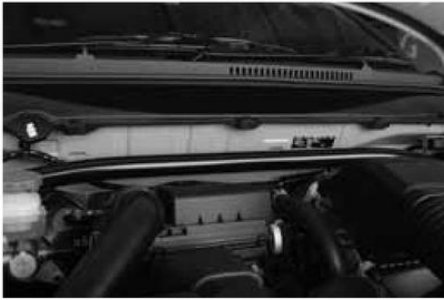
ストラットタワーバーの奥、白い部分にも補強は施されている。ターボRS／ワークスのフロント部はほぼ全域で改変が加えられた。
