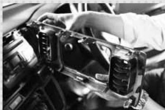
これはオーディオパネル裏面。上4箇所、下3箇所のクリップのほか、左右には各2本のツメがついている。
